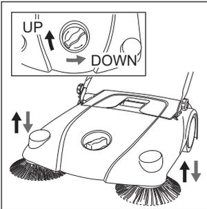
前輪の高さを調整することによりサイドブラシの高さを調整できます。
