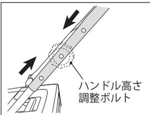
使用する人の体格に合わせてハンドルの高さを3段階で調整することができます。
