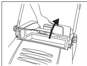
ダストコンテナの取っ手に手をかけ、上に引き上げるとダストコンテナが外れます。
